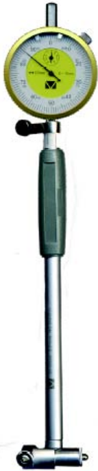
Рисунок А.1 - Нутромір індикаторний з відліковим пристроєм механічного типу з центруючим містком
