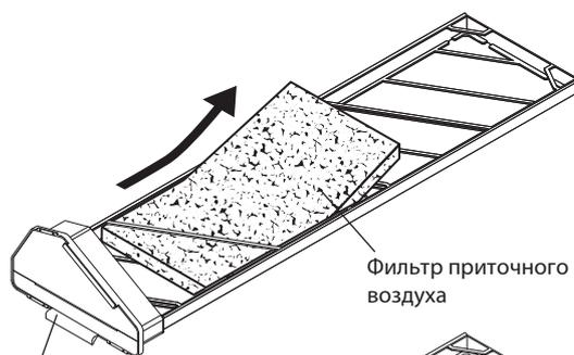
Корпус фильтра приточного воздуха
