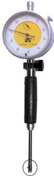
Рисунок А.2 - Нутромір індикаторний з відліковим пристроєм механічного типу без центруючого містка НИ-6-10
